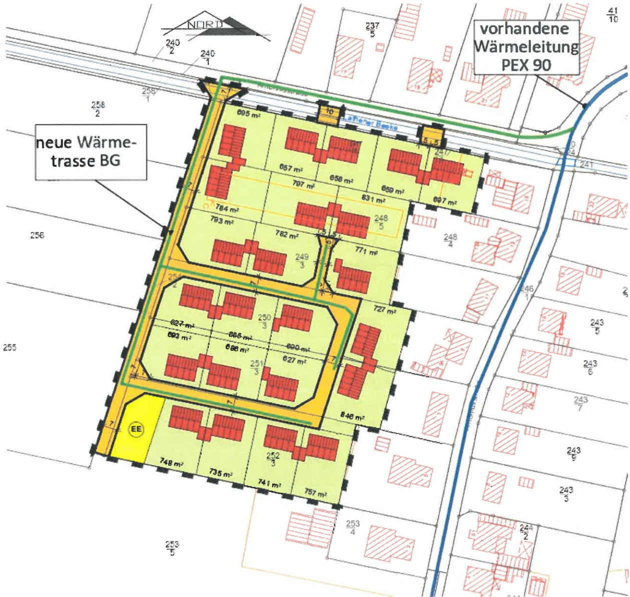
Abbildung 3: Hauptwärme- und Anbindungstrasse Baugebiet
