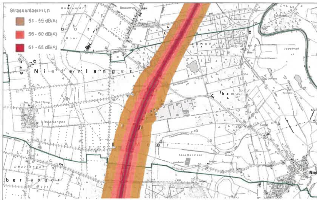
Abbildung 3: Lärmkarte Straßenlärm Niederlangen L Night (22-6 Uhr)
