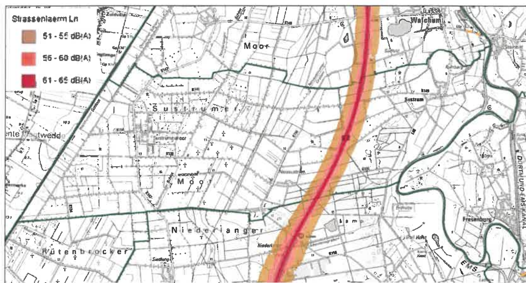
Abbildung 7: Lärmkarte Straßenlärm Sustrum L_{Night} (22-6 Uhr)
